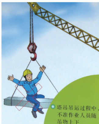
(8) 塔吊使用过程中，不准作业人员随物上下。
