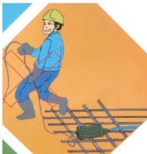
(4) 操作混凝土振捣器应穿胶底鞋，戴手套，严禁用电线拉振捣器，严禁在钢丝网上拉振捣器。
